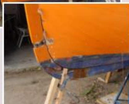
el gaó està trencat
